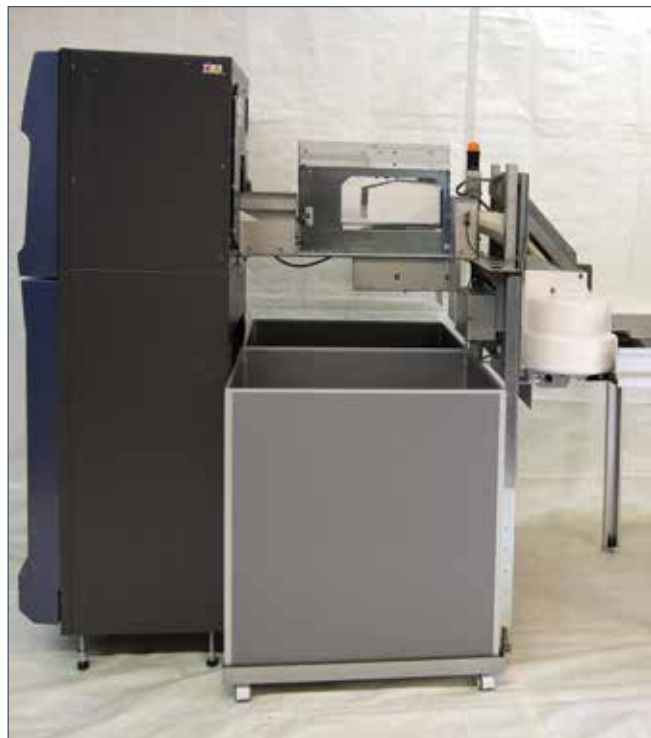
Kunnostettu T-820 automaatti uudella tölkit ja KMP:t säkkiin erottelevalla tilatehokkaalla ratkaisulla. Vähentää yli 80% työkuormasta verrattuna ilman lajittelua olevaan laitteistoon.
