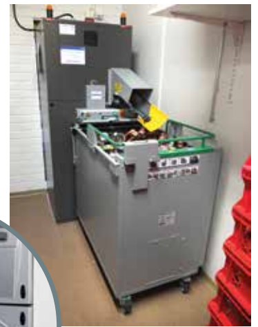
Ylhäällä Tomran T-63 Single ja SoftDrop Free-yhdistelmän tilantarve on alle 2m 2 laitteen kapasiteetista tinkimättä.
